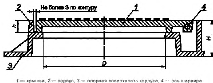
Рисунок А.6 — Люк с крышкой, шарнирно прикрепленной к корпусу
